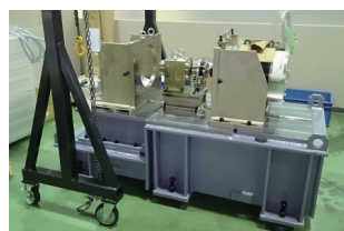
自社所有のモータベンチ15,000min-1/250Nm
